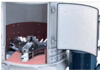
**A** Maintenance facilitée par une large trappe d'accès
