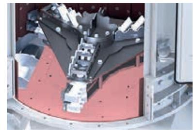
**C** Remplacement aisé des marteaux et plaques d'impact
